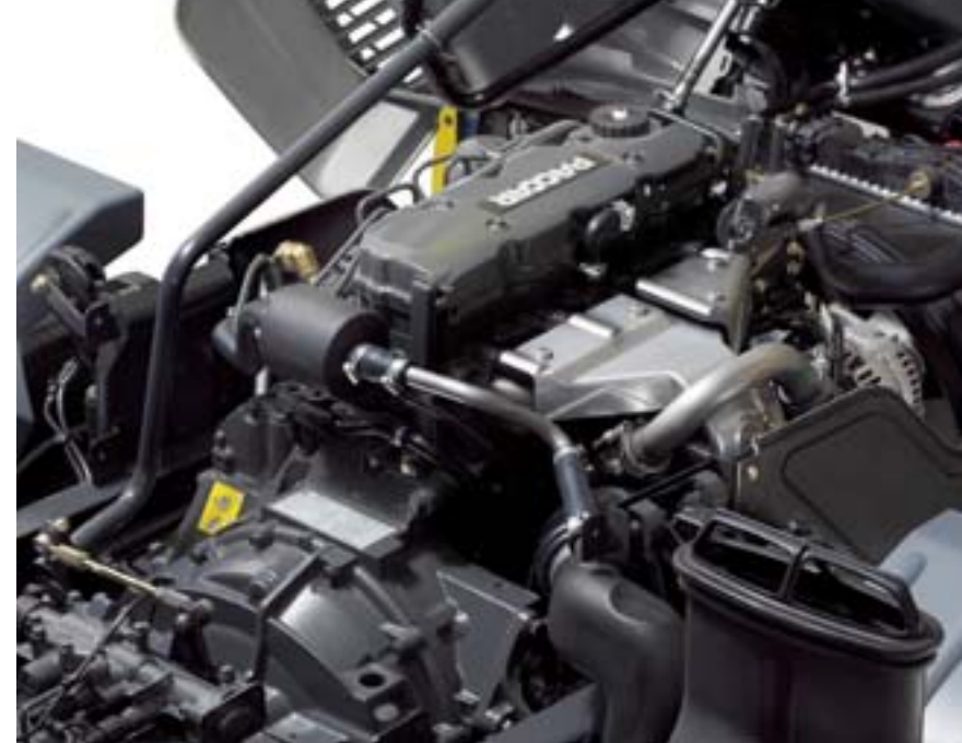
Der neue 4,5-l-Vierzylindermotor FR von PACCAR ist in verschiedenen Leistungsvarianten von 140 bis 180 PS erhältlich.
