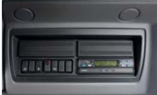
Der Tachograph findet in der Ablage über der Frontscheibe Platz – eine praktische Lösung.
