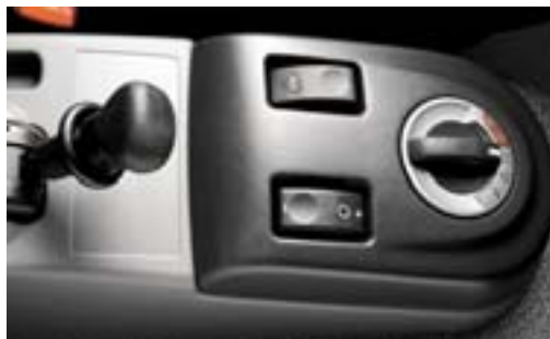
Das Bedienpult für das AS-Tronic-Getriebe befindet sich auf der Konsole neben dem Fahrersitz.
