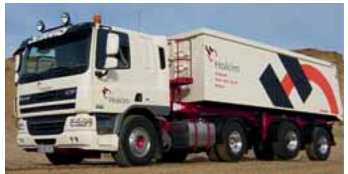
Halterung eingespart. Der nutzlastoptimierte Kippauflieger von Langendorf verfügt über eine doppelwandige Aluminium-Kastenmulde, die 6,50 Meter Ladelänge offeriert und beim Kompaktsattel rund einen Meter kürzer als vergleichbare Standardmulden ist.
