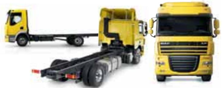
**Jeder DAF-Lkw ist einzigartig. Die Fahrzeuge werden nach Kundenwunsch mit einer großen Auswahl von Fahrerhäusern, Fahrgestellen und Antriebssträngen für leichte, mittelschwere und schwere Einsatzbedingungen individuell zugeschnitten. Der Kunde hat die Wahl zwischen zwei, drei oder vier Achsen, Einzel- oder Doppelantrieb und gelenkter oder ungelenkter Vorlauf- oder Nachlauf-Hinterachse.**
