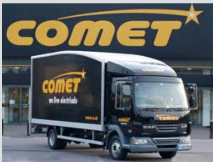
Die LF von Comet haben einen stromlinienförmigen Aufbau, der den Kraftstoffverbrauch um 12 % verringert. Außerdem steigert die einzigartige Form des Aufbaus den Wiedererkennungswert des Unternehmens.
