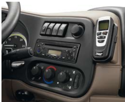
Optionale Unterbringungsmöglichkeit für Mobiltelefon in der Armaturentafel, verkabelt für Anschluss der meisten GSM-Geräte (mit Freisprechanlage) und Lenkradtasten. Eine Telefonantenne ist serienmäßig.
