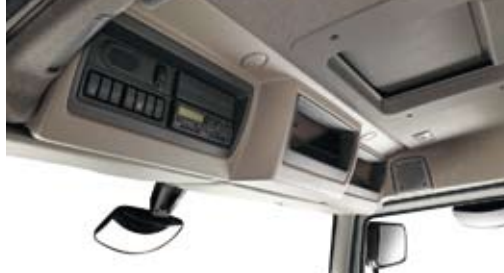
Der digitale Tachograph findet in der Ablage über der Frontscheibe Platz – eine praktische Lösung.
