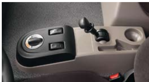
Das Bedienpult für das AS-Tronic-Getriebe befindet sich auf der Konsole neben dem Fahrersitz.
