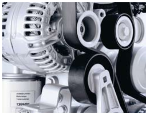
Poly V-Riemen mit Spanner für Zuverlässigkeit und Langlebigkeit.
