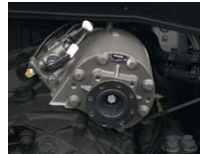
Der effiziente und leistungsstarke Motornebenantrieb erbringt eine Leistung von bis zu 150 kW.
