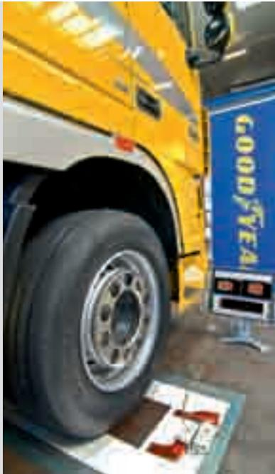
Im Rahmen einer Untersuchung über Reifendruck bei Lkws, die im letzten Jahr von Goodyear vorgenommen wurde, wurde festgestellt, dass 68 % der Lastzüge einen im Durchschnitt 16 % zu niedrigen Reifendruck aufwiesen. Wenn der Reifendruck zu niedrig ist, wird unnötig viel Kraftstoff verbraucht und die Lebensdauer der Reifen verkürzt. In der Praxis scheint insbesondere der Luftdruck der Anhängerbereifung zu niedrig zu sein.
