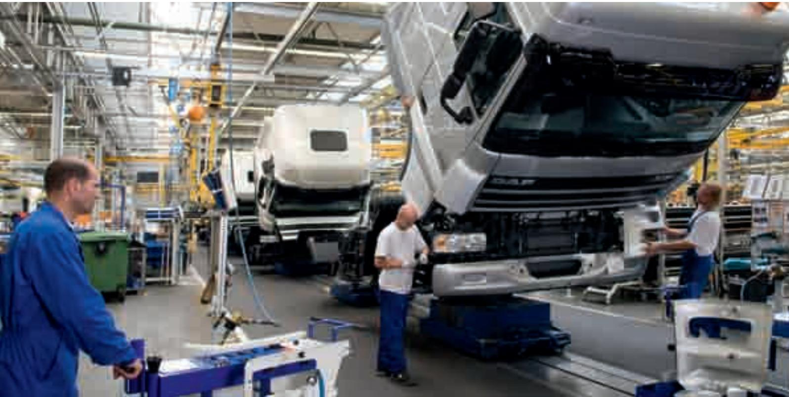
*Six Sigma ist optimal geeignet für die Prozessoptimierung, wie hier im DAF-Lkw-Werk in Eindhoven. Die Bedienungspersonen an den Fertigungsstraßen können sich ganz auf die Montage konzentrieren, während Kollegen dafür verantwortlich sind, rechtzeitig die richtigen Teile zu liefern.*
