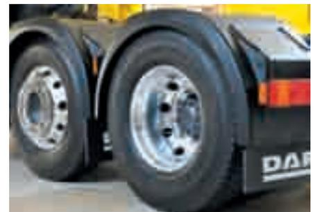
Wenn ein Lkw für längere Zeit stillgelegt wird, müssen die anhebbaren Achsen abgesenkt werden.
