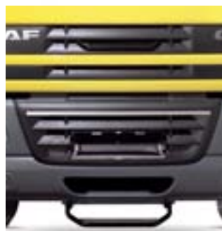
Neuer Einstieg mit drei Stufen für höhere Robustheit. Die mittlere Stufe ist am Fahrgestell befestigt und die untere flexibel montiert.
