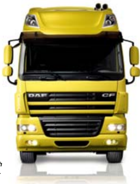
Der CF mit neuem Space Cab-Dach, das – wie auch beim XF105 – gegen Aufpreis mit Skylights ausgestattet werden kann.
