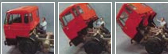
Die Kippvorrichtung war ein Paradebeispiel für die Kreativität der DAF-Ingenieure.
