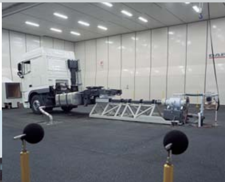
Oben: Rechts die Fahrtwindsimulation, in der Mitte das getestete Fahrzeug und dahinter die Wasserbremse, die den Antriebsstrang während des Versuchs so belastet, als ob der Lkw auf der Straße unterwegs wäre. Im Vordergrund zwei hochempfindliche Mikrophone.
