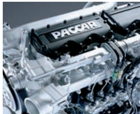
Die EEV-Motoren von DAF basieren auf dem neuen 9,2-Liter-PR-Motor für Euro 5 und sind mit einem passiven Rußfilter ausgestattet.
