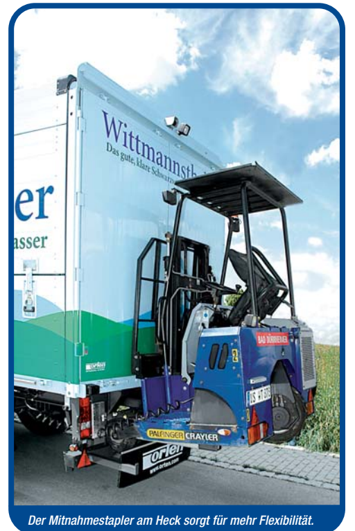
Der Mitnahmestapler am Heck sorgt für mehr Flexibilität.
