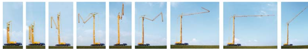
Automatischer Aufbau des Großkrans
